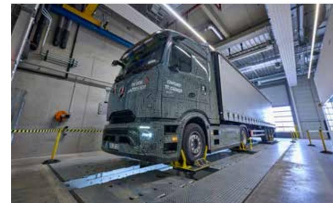
Ein eActros 600 auf der sogenannten Multi-Stempelanlage im Lkw-Werk in Würth. Die laut Daimler Truck „weltweit vermutlich einzigartige“ Anlage dient zur Analyse des Schwingungsverhaltens von Fahrzeugen mit Hinblick auf Fahrerkomfort und Sicherheit.
